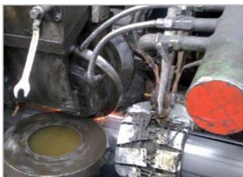
Surveillance de la température des bords du tube juste avant le procédé de soudure
