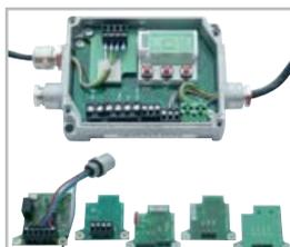
Modules d'interface numérique pour boîtier électronique
