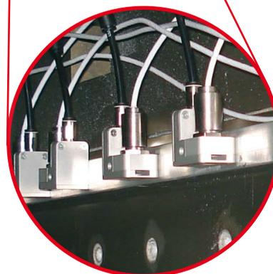
*Ill. 1: Petite tête de mesure de l'optris CT LT ; Têtes de mesure installées en machine avec buse de soufflage d'air laminaire, pour la surveillance de la température lors du thermoformage*
