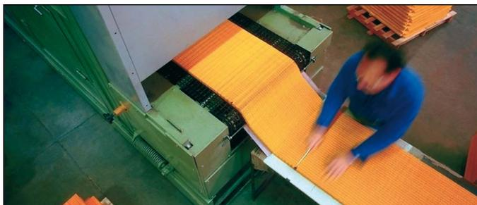
III. 2 : Surveillance continue de la température sur une calandre d'embossage, réalisée par le thermomètre infrarouge optris CT LT
